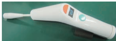
磁性マーカー(左、ガイディングマーカーシステム、八光)を乳房内に挿入、留置し、磁気プローブ(上、TAKUMI、マトリクス細胞研究所)によりマーカーを感知しながら、確実に腫瘍を切除できる
